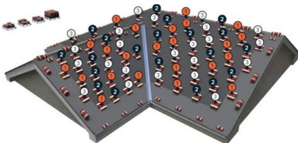
Figure 3.3.2 Mezcla de Colores de las Diferentes Paletas
